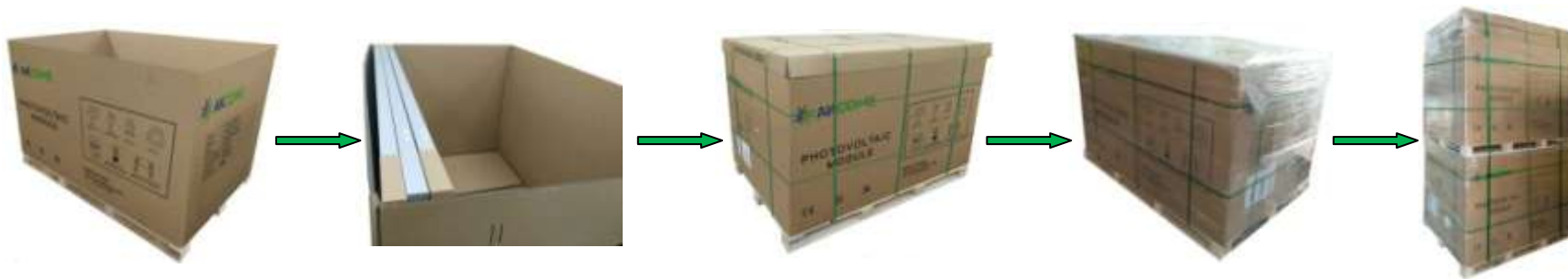
图3 SK6612系列组件装箱流程
