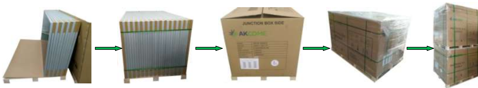
图1 SK6610系列组件装箱流程
